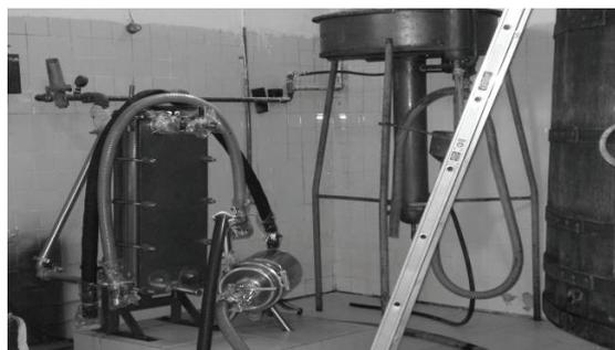
**Figura 7** - Pasteurizador de Placas.
